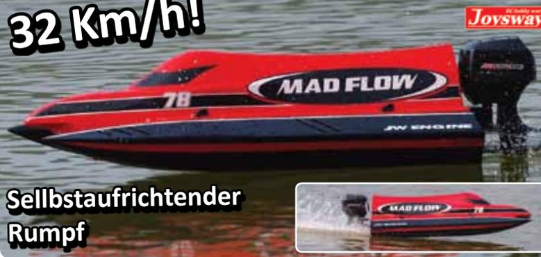
Die Mad Flow F1 "Brushed" ARTR von Joysway ist eine Omage an die ultra schnellen F1 Katamaran Rennboote, bis hin zur Attrappe des Außenbordmotors! Durch den abnehmbaren Rumpfrücken kommt man leicht an alle vormontierten Komponenten wie den wassergekühlten Bürstenmotor, den Regler, 9g Servo und 2,4 GHz Empfänger. Joysway's 2 Kanal Sender mit Trimmfunktionen komplettiert das gesamte Paket. Benötigt werden noch ein 11,1V 1300mAh Akku und ein passendes Ladegerät.
